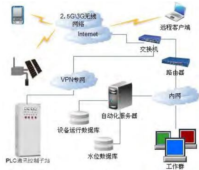
图 8-1: 自动化控制系统图
